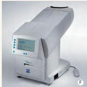
D NAVIS (画像ファイリングシステム) により全データがいつでも呼び出し患者様への説明や紹介状に。E ハンプリー視野計により緑内障等の視野検査を行います。F Zeiss社のFDTはハンプリー視野計では検出できない軽度の視野異常・感度低下も検出します。G Zeiss顕微鏡に搭載されたレーザー装置。大病院に転院せず日帰りで治療が受けられます。
